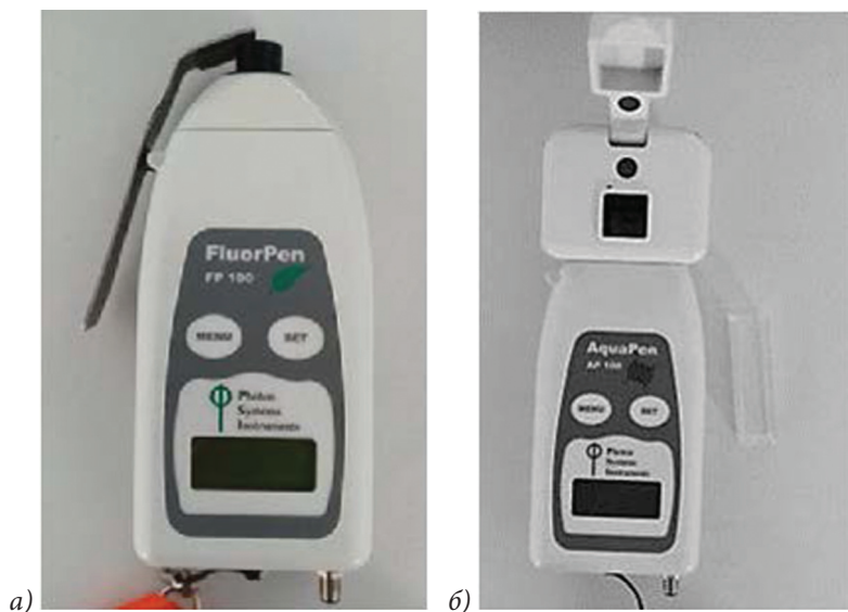
Рис. 3. Портативные флуориметры: а) FluorPen FP 100, модифицированный под использование клипсов; б) AquaPen AP 100 (кюветный)
