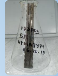
Разрез строительной арматуры
