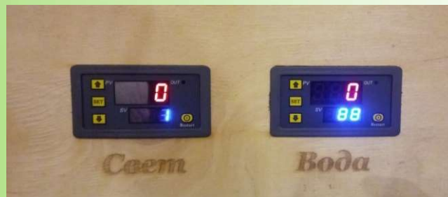
Программирование датчиков времени работы насоса и лампы
