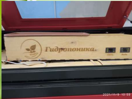
Изготовление коробки для размещения емкостей и датчиков
