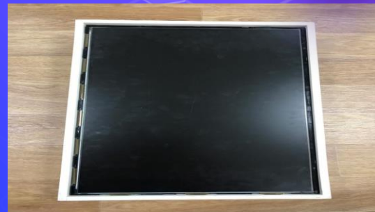
Установка Экрана в каркас
